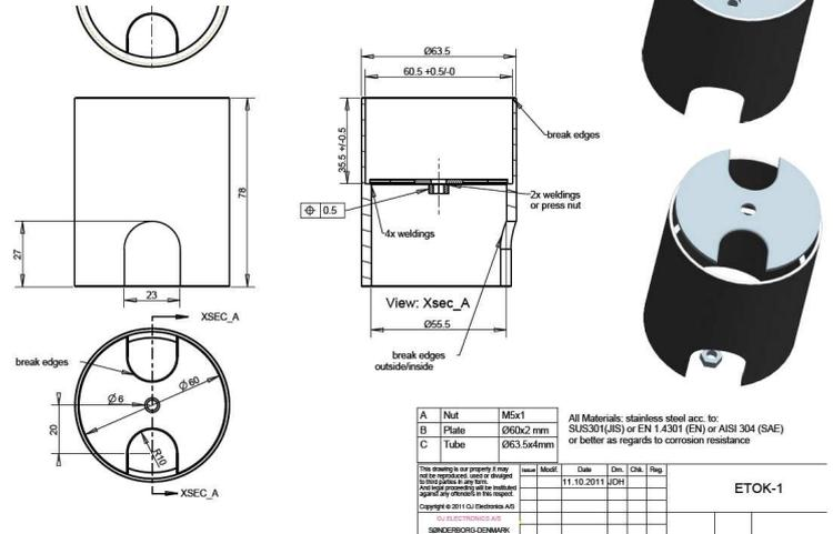
La sonde de parking se glisse aisément dans la boîte d'encastrement. Elle est maintenue fixée par le fond à l'aide d'un écrou de 5 mm. Le câble d'alimentation de la sonde est situé dans le bas de la sonde pour une sortie aisée. La sonde de parking est la solution incontournable pour réaliser des économies d'énergie. Elle est livrée avec un câble d'alimentation de 25 mètres.
