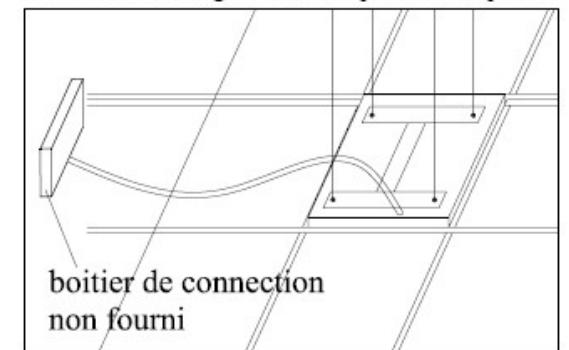
Cassette AX intégrée dans un plafond suspendu
