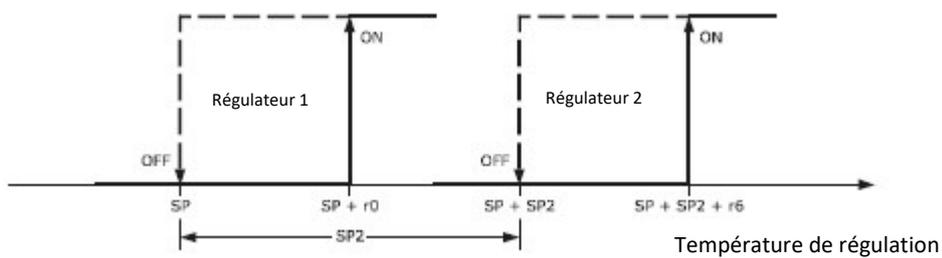
Consigne 1 de régulation en mode froid ( $r_5 = 0$ ) et consigne 2 de régulation en mode chaud ( $r_{10} = 1$ )
