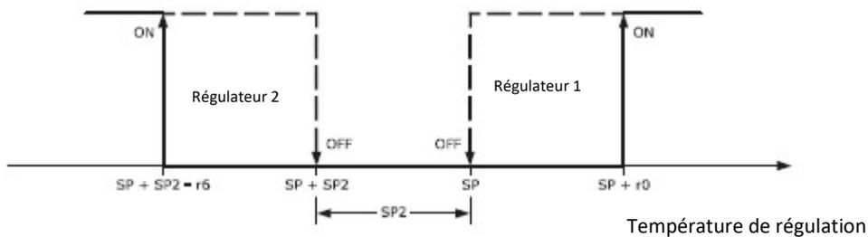
Consigne 1 de régulation en mode chaud ( $r_5 = 1$ ) et consigne 2 de régulation en mode froid ( $r_{10} = 0$ )
