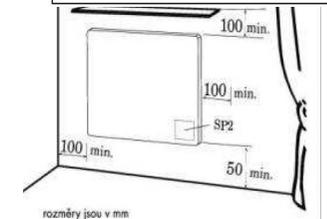
rozměry jsou v mm
